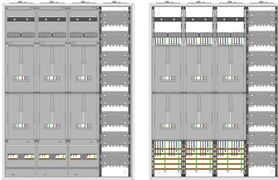
AZ82HM2-210-2, Zählerverteilung mit 3-Punktbefestigung nach VDE 0603, DIN43870, AR-N 4101:2015 für den Innenbereich für Wandbefestigung AP/UP, Fabr. Alphatec, BxHxT [mm] = 1050x1400x210, Schutzklasse II, IP41, RAL 9016, Bestehend aus: Gehäuse, Einzel- bzw. Doppeltür mit Drehriegel, Flansche NF1 (oben) und NF2 (unten) und Berührungsschutzabdeckungen, aufgebaut wie folgt: 6xZählerplatz, Medienfeld, externer APZ erforderlich, komplett zusammengebaut und verdrahtet gemäß VNB.0063
