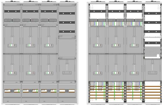
AZ82H1A-230, Zählerverteilung mit 3-Punktnach VDE 0603, DIN43870, AR-N 4101:2015 für den Innenbereich für Wandbefestigung AP/UP, Fabr. Alphatec, BxHxT [mm] = 1050x1400x230, Schutzklasse II, IP54, RAL 7035, Bestehend aus: Gehäuse, Einzel- bzw. Doppeltür mit Drehriegel, Flansche SF45 (oben) und SF41 (unten) und Berührungsschutzabdeckungen, aufgebaut wie folgt: 6xZählerplatz, TSG, Verteilerfeld (12TE), APZ in Verteilerfeld, komplett zusammengebaut und verdrahtet gemäß VNB.0182
