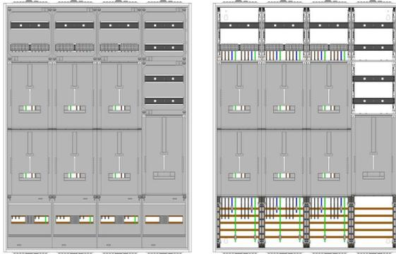
AZ82H-230-2, Zählerverteilung mit 3-Punktnach VDE 0603, DIN43870, AR-N 4101:2015 für den Innenbereich für Wandbefestigung AP/UP, Fabr. Alphatec, BxHxT [mm] = 1050x1400x230, Schutzklasse II, IP54, RAL 7035, Bestehend aus: Gehäuse, Einzel- bzw. Doppeltür mit Drehriegel, Flansche SF45 (oben) und SF41 (unten) und Berührungsschutzabdeckungen, aufgebaut wie folgt: 7xZählerplatz, komplett zusammengebaut und verdrahtet gemäß VNB.0138
