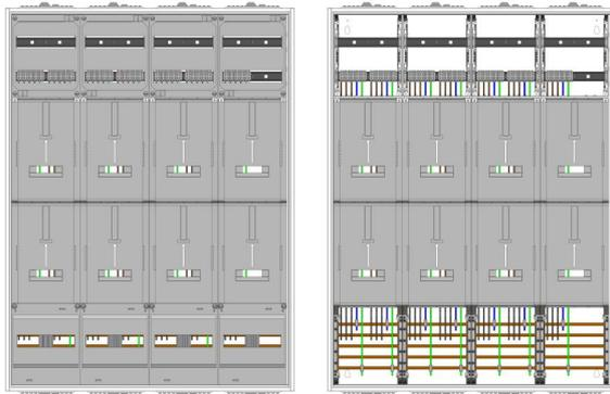
AZ82H-210, Zählerverteilung für Zählerplatz mit 3-Punktbefestigung nach VDE 0603, DIN43870, AR-N 4101:2015 für den Innenbereich für Wandbefestigung AP/UP, Fabr. Alphatec, BxHxT [mm] = 1050x1400x210, Schutzklasse II, IP41, RAL 9016, Bestehend aus: Gehäuse, Doppeltür mit Drehriegel, Flansche NF1 (oben) und NF2 (unten) und Berührungsschutzabdeckungen, aufgebaut wie folgt: 7x Zählerplatz, 1x TSG-Platte, komplett zusammengebaut und verdrahtet gemäß VNB.0001
