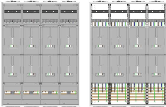
AZ82H-210-8, Zählerverteilung für Zählerplatz mit 3-Punktbefestigung nach VDE 0603, DIN43870, AR-N 4101:2015 für den Innenbereich für Wandbefestigung AP/UP, Fabr. Alphatec, BxHxT [mm] = 1050x1400x210, Schutzklasse II, IP41, RAL 9016, Bestehend aus: Gehäuse, Doppeltür mit Drehriegel, Flansche NF1 (oben) und NF2 (unten) und Berührungsschutzabdeckungen, aufgebaut wie folgt: 8x Zählerplatz, komplett zusammengebaut und verdrahtet gemäß VNB.0001
