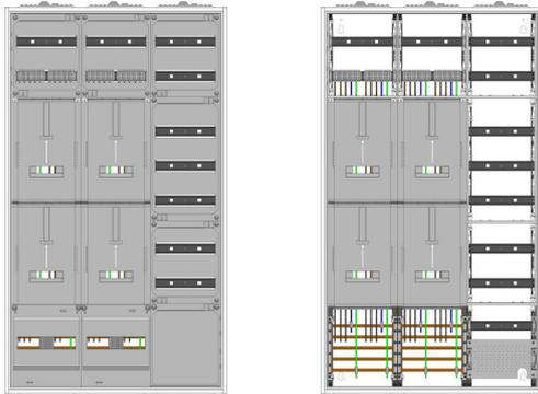
AZ62HS2A-210, Zählerverteilung mit 3-Punktbefestigung nach VDE 0603, DIN43870, AR-N 4101:2015 für den Innenbereich für Wandbefestigung AP/UP, Fabr. Alphatec, BxHxT [mm] = 800x1400x210, Schutzklasse II, IP41, RAL 9016, Bestehend aus: Gehäuse, Einzel- bzw. Doppeltür mit Drehriegel, Flansche NF1 (oben) und NF2 (unten) und Berührungsschutzabdeckungen, aufgebaut wie folgt: 4xZählerplatz, Verteilerfeld (12TE), APZ in Verteilerfeld, komplett zusammengebaut und verdrahtet gemäß VNB.0060
