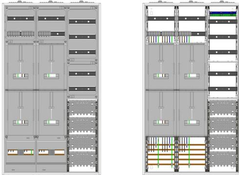
AZ62HS1M1-230, Zählerverteilung mit 3-Punktnach VDE 0603, DIN43870, AR-N 4101:2015 für den Innenbereich für Wandbefestigung AP/UP, Fabr. Alphatec, BxHxT [mm] = 800x1400x230, Schutzklasse II, IP54, RAL 7035, Bestehend aus: Gehäuse, Einzel- bzw. Doppeltür mit Drehriegel, Flansche SF45 (oben) und SF41 (unten) und Berührungsschutzabdeckungen, aufgebaut wie folgt: 3xZählerplatz, TSG, Verteilerfeld (12TE), Medienfeld, externer APZ erforderlich, komplett zusammengebaut und verdrahtet gemäß VNB.0136
