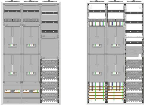
AZ62HS1AM1-230, Zählerverteilung mit 3-Punktnach VDE 0603, DIN43870, AR-N 4101:2015 für den Innenbereich für Wandbefestigung AP/UP, Fabr. Alphatec, BxHxT [mm] = 800x1400x230, Schutzklasse II, IP54, RAL 7035, Bestehend aus: Gehäuse, Einzel- bzw. Doppeltür mit Drehriegel, Flansche SF45 (oben) und SF41 (unten) und Berührungsschutzabdeckungen, aufgebaut wie folgt: 4xZählerplatz, APZ in Medienfeld, komplett zusammengebaut und verdrahtet gemäß VNB.0180
