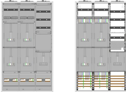
AZ62HS1A-230, Zählerverteilung mit 3-Punktnach VDE 0603, DIN43870, AR-N 4101:2015 für den Innenbereich für Wandbefestigung AP/UP, Fabr. Alphatec, BxHxT [mm] = 800x1400x230, Schutzklasse II, IP54, RAL 7035, Bestehend aus: Gehäuse, Einzel- bzw. Doppeltür mit Drehriegel, Flansche SF45 (oben) und SF41 (unten) und Berührungsschutzabdeckungen, aufgebaut wie folgt: 4xZählerplatz, TSG, Verteilerfeld (12TE), APZ in Verteilerfeld, komplett zusammengebaut und verdrahtet gemäß VNB.0179
