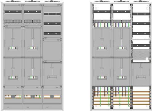
AZ62HS1A-210, Zählerverteilung mit 3-Punktbefestigung nach VDE 0603, DIN43870, AR-N 4101:2015 für den Innenbereich für Wandbefestigung AP/UP, Fabr. Alphatec, BxHxT [mm] = 800x1400x210, Schutzklasse II, IP41, RAL 9016, Bestehend aus: Gehäuse, Einzel- bzw. Doppeltür mit Drehriegel, Flansche NF1 (oben) und NF2 (unten) und Berührungsschutzabdeckungen, aufgebaut wie folgt: 4xZählerplatz, TSG, Verteilerfeld (12TE), APZ in Verteilerfeld, komplett zusammengebaut und verdrahtet gemäß VNB.0058
