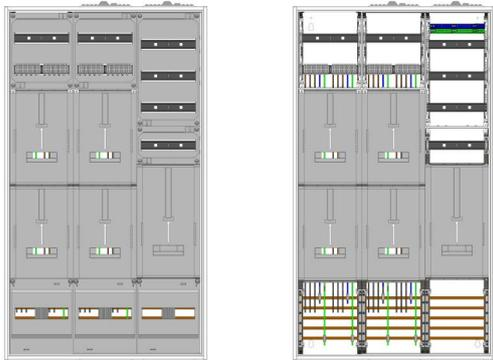
AZ62HS1-230, Zählerverteilung mit 3-Punktnach VDE 0603, DIN43870, AR-N 4101:2015 für den Innenbereich für Wandbefestigung AP/UP, Fabr. Alphatec, BxHxT [mm] = 800x1400x230, Schutzklasse II, IP54, RAL 7035, Bestehend aus: Gehäuse, Einzel- bzw. Doppeltür mit Drehriegel, Flansche SF45 (oben) und SF41 (unten) und Berührungsschutzabdeckungen, aufgebaut wie folgt: 4xZählerplatz, TSG, Verteilerfeld (12TE), externer APZ erforderlich, komplett zusammengebaut und verdrahtet gemäß VNB.0135
