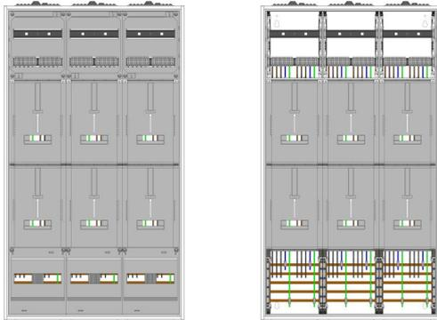
AZ62H-230-6, Zählerverteilung mit 3-Punktnach VDE 0603, DIN43870, AR-N 4101:2015 für den Innenbereich für Wandbefestigung AP/UP, Fabr. Alphatec, BxHxT [mm] = 800x1400x230, Schutzklasse II, IP54, RAL 7035, Bestehend aus: Gehäuse, Einzel- bzw. Doppeltür mit Drehriegel, Flansche SF45 (oben) und SF41 (unten) und Berührungsschutzabdeckungen, aufgebaut wie folgt: 6xZählerplatz, externer APZ erforderlich, komplett zusammengebaut und verdrahtet gemäß VNB.0134
