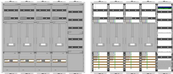
AZ52BSA-230-2, Zählerverteilung mit 3-Punktnach VDE 0603, DIN43870, AR-N 4101:2015 für den Innenbereich für Wandbefestigung AP/UP, Fabr. Alphatec, BxHxT [mm] = 1300x1100x230, Schutzklasse II, IP54, RAL 7035, Bestehend aus: Gehäuse, Einzel- bzw. Doppeltür mit Drehriegel, Flansche SF45 (oben) und SF41 (unten) und Berührungsschutzabdeckungen, aufgebaut wie folgt: 4xZählerplatz, Verteilerfeld (12TE), APZ in Verteilerfeld, komplett zusammengebaut und verdrahtet gemäß VNB.0178
