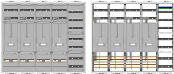
AZ52BS-210-2, Zählerverteilung mit 3-Punktbefestigung nach VDE 0603, DIN43870, AR-N 4101:2015 für den Innenbereich für Wandbefestigung AP/UP, Fabr. Alphatec, BxHxT [mm] = 1300x1100x210, Schutzklasse II, IP41, RAL 9016, Bestehend aus: Gehäuse, Einzel- bzw. Doppeltür mit Drehriegel, Flansche NF1 (oben) und NF2 (unten) und Berührungsschutzabdeckungen, aufgebaut wie folgt: 4xZählerplatz, Verteilerfeld (12TE), externer APZ erforderlich, komplett zusammengebaut und verdrahtet gemäß VNB.0056
