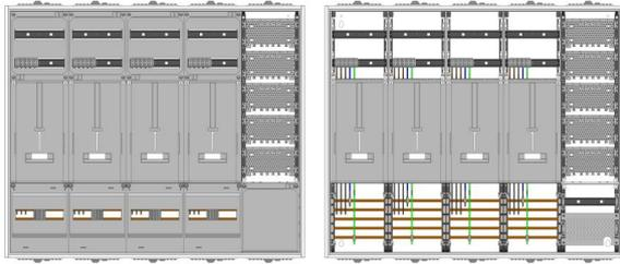
AZ52BMA-230, Zählerverteilung mit 3-Punktnach VDE 0603, DIN43870, AR-N 4101:2015 für den Innenbereich für Wandbefestigung AP/UP, Fabr. Alphatec, BxHxT [mm] = 1300x1100x230, Schutzklasse II, IP54, RAL 7035, Bestehend aus: Gehäuse, Einzel- bzw. Doppeltür mit Drehriegel, Flansche SF45 (oben) und SF41 (unten) und Berührungsschutzabdeckungen, aufgebaut wie folgt: 4xZählerplatz, APZ in Medienfeld, komplett zusammengebaut und verdrahtet gemäß VNB.0176
