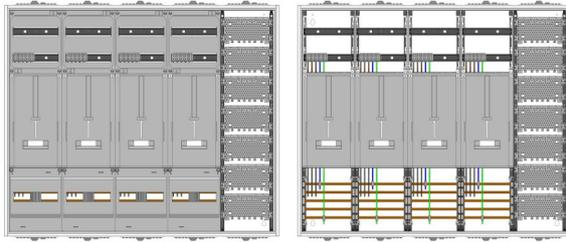
AZ52BM-230, Zählerverteilung mit 3-Punktnach VDE 0603, DIN43870, AR-N 4101:2015 für den Innenbereich für Wandbefestigung AP/UP, Fabr. Alphatec, BxHxT [mm] = 1300x1100x230, Schutzklasse II, IP54, RAL 7035, Bestehend aus: Gehäuse, Einzel- bzw. Doppeltür mit Drehriegel, Flansche SF45 (oben) und SF41 (unten) und Berührungsschutzabdeckungen, aufgebaut wie folgt: 4xZählerplatz, Medienfeld, externer APZ erforderlich, komplett zusammengebaut und verdrahtet gemäß VNB.0175
