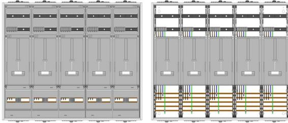
AZ52B-210-5, Zählerverteilung für Zählerplatz mit 3-Punktbefestigung nach VDE 0603, DIN43870, AR-N 4101:2015 für den Innenbereich für Wandbefestigung AP/UP, Fabr. Alphatec, BxHxT [mm] = 1300x1100x210, Schutzklasse II, IP41, RAL 9016, Bestehend aus: Gehäuse, Doppeltür mit Drehriegel, Flansche NF1 (oben) und NF2 (unten) und Berührungsschutzabdeckungen, aufgebaut wie folgt: 5x Zählerplatz, komplett zusammengebaut und verdrahtet gemäß VNB.0001
