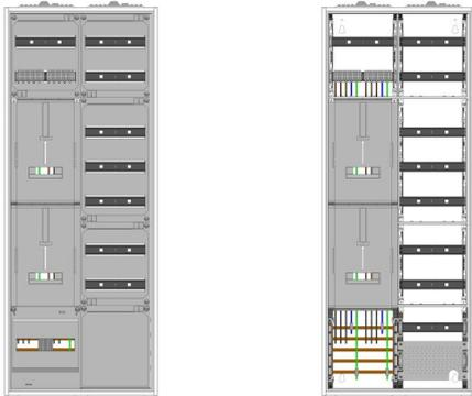
AZ42HS2A-210, Zählerverteilung mit 3-Punktbefestigung nach VDE 0603, DIN43870, AR-N 4101:2015 für den Innenbereich für Wandbefestigung AP/UP, Fabr. Alphatec, BxHxT [mm] = 550x1400x210, Schutzklasse II, IP41, RAL 9016, Bestehend aus: Gehäuse, Einzel- bzw. Doppeltür mit Drehriegel, Flansche NF1 (oben) und NF2 (unten) und Berührungsschutzabdeckungen, aufgebaut wie folgt: 2xZählerplatz, Verteilerfeld (12TE), APZ in Verteilerfeld, komplett zusammengebaut und verdrahtet gemäß VNB.0053
