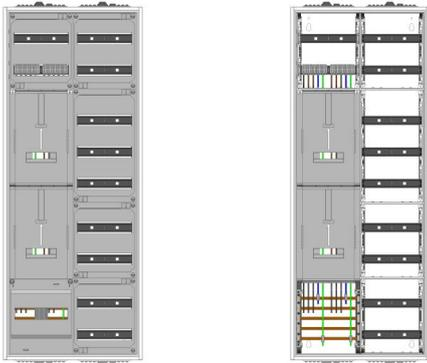
AZ42HS2-230, Zählerverteilung mit 3-Punktnach VDE 0603, DIN43870, AR-N 4101:2015 für den Innenbereich für Wandbefestigung AP/UP, Fabr. Alphatec, BxHxT [mm] = 550x1400x230, Schutzklasse II, IP54, RAL 7035, Bestehend aus: Gehäuse, Einzel- bzw. Doppeltür mit Drehriegel, Flansche SF45 (oben) und SF41 (unten) und Berührungsschutzabdeckungen, aufgebaut wie folgt: 1xZählerplatz, TSG, Verteilerfeld (12TE), externer APZ erforderlich, komplett zusammengebaut und verdrahtet gemäß VNB.0132
