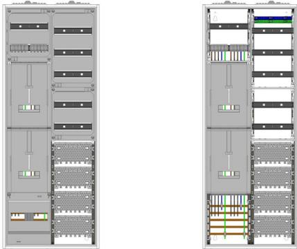
AZ42HS1M1-230, Zählerverteilung mit 3-Punktnach VDE 0603, DIN43870, AR-N 4101:2015 für den Innenbereich für Wandbefestigung AP/UP, Fabr. Alphatec, BxHxT [mm] = 550x1400x230, Schutzklasse II, IP54, RAL 7035, Bestehend aus: Gehäuse, Einzel- bzw. Doppeltür mit Drehriegel, Flansche SF45 (oben) und SF41 (unten) und Berührungsschutzabdeckungen, aufgebaut wie folgt: 1xZählerplatz, TSG, Verteilerfeld (12TE), Medienfeld, externer APZ erforderlich, komplett zusammengebaut und verdrahtet gemäß VNB.0131
