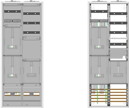
AZ42HS1A-230, Zählerverteilung mit 3-Punktnach VDE 0603, DIN43870, AR-N 4101:2015 für den Innenbereich für Wandbefestigung AP/UP, Fabr. Alphatec, BxHxT [mm] = 550x1400x230, Schutzklasse II, IP54, RAL 7035, Bestehend aus: Gehäuse, Einzel- bzw. Doppeltür mit Drehriegel, Flansche SF45 (oben) und SF41 (unten) und Berührungsschutzabdeckungen, aufgebaut wie folgt: 2xZählerplatz, TSG, Verteilerfeld (12TE), APZ in Verteilerfeld, komplett zusammengebaut und verdrahtet gemäß VNB.0172
