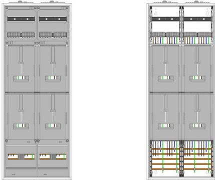
AZ42H-230-4, Zählerverteilung mit 3-Punktnach VDE 0603, DIN43870, AR-N 4101:2015 für den Innenbereich für Wandbefestigung AP/UP, Fabr. Alphatec, BxHxT [mm] = 550x1400x230, Schutzklasse II, IP54, RAL 7035, Bestehend aus: Gehäuse, Einzel- bzw. Doppeltür mit Drehriegel, Flansche SF45 (oben) und SF41 (unten) und Berührungsschutzabdeckungen, aufgebaut wie folgt: 4xZählerplatz, externer APZ erforderlich, komplett zusammengebaut und verdrahtet gemäß VNB.0129
