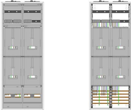
AZ42H-210, Zählerverteilung für Zählerplatz mit 3-Punktbefestigung nach VDE 0603, DIN43870, AR-N 4101:2015 für den Innenbereich für Wandbefestigung AP/UP, Fabr. Alphatec, BxHxT [mm] = 550x1400x210, Schutzklasse II, IP41, RAL 9016, Bestehend aus: Gehäuse, Einzeltür mit Drehriegel, Flansche NF1 (oben) und NF2 (unten) und Berührungsschutzabdeckungen, aufgebaut wie folgt: 3x Zählerplatz, 1x TSG-Platte, komplett zusammengebaut und verdrahtet gemäß VNB.0001
