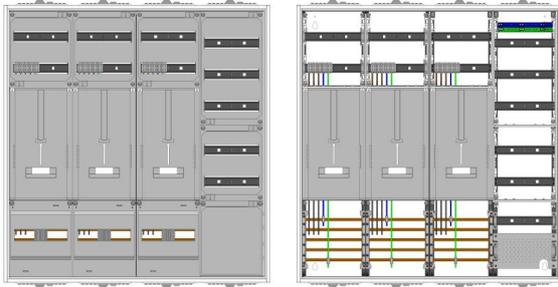
AZ42BSA-230-2, Zählerverteilung mit 3-Punktnach VDE 0603, DIN43870, AR-N 4101:2015 für den Innenbereich für Wandbefestigung AP/UP, Fabr. Alphatec, BxHxT [mm] = 550x1100x230, Schutzklasse II, IP54, RAL 7035, Bestehend aus: Gehäuse, Einzel- bzw. Doppeltür mit Drehriegel, Flansche SF45 (oben) und SF41 (unten) und Berührungsschutzabdeckungen, aufgebaut wie folgt: 3xZählerplatz, Verteilerfeld (12TE), APZ in Verteilerfeld, komplett zusammengebaut und verdrahtet gemäß VNB.0171
