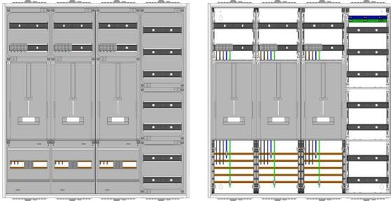
AZ42BS-230-2, Zählerverteilung mit 3-Punktnach VDE 0603, DIN43870, AR-N 4101:2015 für den Innenbereich für Wandbefestigung AP/UP, Fabr. Alphatec, BxHxT [mm] = 550x1100x230, Schutzklasse II, IP54, RAL 7035, Bestehend aus: Gehäuse, Einzel- bzw. Doppeltür mit Drehriegel, Flansche SF45 (oben) und SF41 (unten) und Berührungsschutzabdeckungen, aufgebaut wie folgt: 3xZählerplatz, Verteilerfeld (12TE), externer APZ erforderlich, komplett zusammengebaut und verdrahtet gemäß VNB.0170
