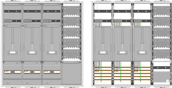
AZ42BMA-230, Zählerverteilung mit 3-Punktnach VDE 0603, DIN43870, AR-N 4101:2015 für den Innenbereich für Wandbefestigung AP/UP, Fabr. Alphatec, BxHxT [mm] = 550x1100x230, Schutzklasse II, IP54, RAL 7035, Bestehend aus: Gehäuse, Einzel- bzw. Doppeltür mit Drehriegel, Flansche SF45 (oben) und SF41 (unten) und Berührungsschutzabdeckungen, aufgebaut wie folgt: 2xZählerplatz, TSG, APZ in Medienfeld, komplett zusammengebaut und verdrahtet gemäß VNB.0168
