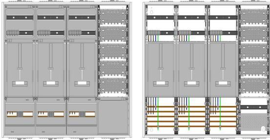
AZ42BMA-230-2, Zählerverteilung mit 3-Punktnach VDE 0603, DIN43870, AR-N 4101:2015 für den Innenbereich für Wandbefestigung AP/UP, Fabr. Alphatec, BxHxT [mm] = 550x1100x230, Schutzklasse II, IP54, RAL 7035, Bestehend aus: Gehäuse, Einzel- bzw. Doppeltür mit Drehriegel, Flansche SF45 (oben) und SF41 (unten) und Berührungsschutzabdeckungen, aufgebaut wie folgt: 3xZählerplatz, APZ in Medienfeld, komplett zusammengebaut und verdrahtet gemäß VNB.0169
