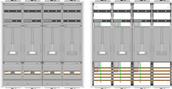
AZ42B-210, Zählerverteilung für Zählerplatz mit 3-Punktbefestigung nach VDE 0603, DIN43870, AR-N 4101:2015 für den Innenbereich für Wandbefestigung AP/UP, Fabr. Alphatec, BxHxT [mm] = 1050x1100x210, Schutzklasse II, IP41, RAL 9016, Bestehend aus: Gehäuse, Doppeltür mit Drehriegel, Flansche NF1 (oben) und NF2 (unten) und Berührungsschutzabdeckungen, aufgebaut wie folgt: 3x Zählerplatz, 1x TSG-Platte, komplett zusammengebaut und verdrahtet gemäß VNB.0001
