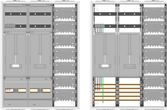
AZ32BM-230, Zählerverteilung mit 3-Punktnach VDE 0603, DIN43870, AR-N 4101:2015 für den Innenbereich für Wandbefestigung AP/UP, Fabr. Alphatec, BxHxT [mm] = 800x1100x230, Schutzklasse II, IP54, RAL 7035, Bestehend aus: Gehäuse, Einzel- bzw. Doppeltür mit Drehriegel, Flansche SF45 (oben) und SF41 (unten) und Berührungsschutzabdeckungen, aufgebaut wie folgt: 1xZählerplatz, TSG, Medienfeld, externer APZ erforderlich, komplett zusammengebaut und verdrahtet gemäß VNB.0162
