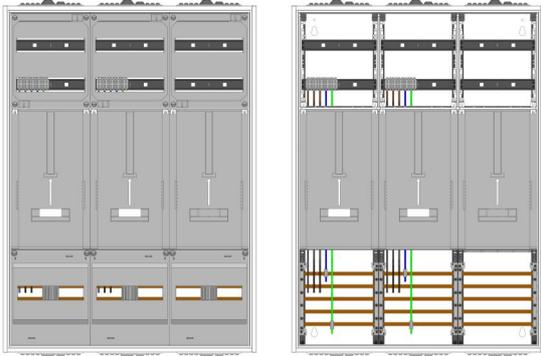
AZ32B-210, Zählerverteilung für Zählerplatz mit 3-Punktbefestigung nach VDE 0603, DIN43870, AR-N 4101:2015 für den Innenbereich für Wandbefestigung AP/UP, Fabr. Alphatec, BxHxT [mm] = 800x1100x210, Schutzklasse II, IP41, RAL 9016, Bestehend aus: Gehäuse, Doppeltür mit Drehriegel, Flansche NF1 (oben) und NF2 (unten) und Berührungsschutzabdeckungen, aufgebaut wie folgt: 2x Zählerplatz, 1x TSG-Platte, komplett zusammengebaut und verdrahtet gemäß VNB.0001
