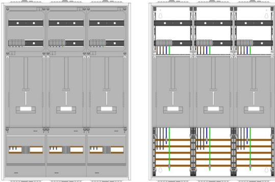
AZ32B-210-3, Zählerverteilung für Zählerplatz mit 3-Punktbefestigung nach VDE 0603, DIN43870, AR-N 4101:2015 für den Innenbereich für Wandbefestigung AP/UP, Fabr. Alphatec, BxHxT [mm] = 800x1100x210, Schutzklasse II, IP41, RAL 9016, Bestehend aus: Gehäuse, Doppeltür mit Drehriegel, Flansche NF1 (oben) und NF2 (unten) und Berührungsschutzabdeckungen, aufgebaut wie folgt: 3x Zählerplatz, komplett zusammengebaut und verdrahtet gemäß VNB.0001
