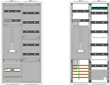
AZ22BSA-230, Zählerverteilung für Zählerplatz mit 3-Punktbefestigung nach VDE 0603, DIN43870, AR-N 4101:2015 für den Innenbereich für Wandbefestigung AP/UP, Fabr.
