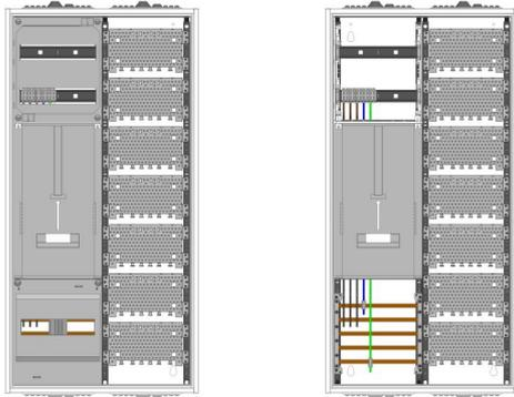
AZ22BM-230, Zählerverteilung mit 3-Punktnach VDE 0603, DIN43870, AR-N 4101:2015 für den Innenbereich für Wandbefestigung AP/UP, Fabr. Alphatec, BxHxT [mm] = 550x1100x230, Schutzklasse II, IP54, RAL 7035, Bestehend aus: Gehäuse, Einzel- bzw. Doppeltür mit Drehriegel, Flansche SF45 (oben) und SF41 (unten) und Berührungsschutzabdeckungen, aufgebaut wie folgt: 1xZählerplatz, Medienfeld, externer APZ erforderlich, komplett zusammengebaut und verdrahtet gemäß VNB.0160
