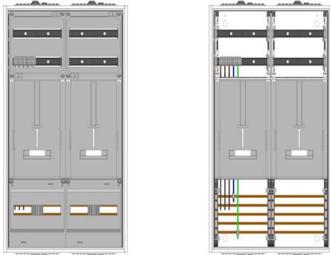
AZ22B-230, Zählerverteilung für Zählerplatz mit 3-Punktbefestigung nach VDE 0603, DIN43870, AR-N 4101:2015 für den Innenbereich für Wandbefestigung AP/UP, Fabr. Alphatec, BxHxT [mm] = 550x1100x230, Schutzklasse II, IP54, RAL 7035, Bestehend aus: Gehäuse, Einzeltür mit Schwenkebel für Profilhalbzylinder, Flansche SF45 (oben) und SF41 (unten) und Berührungsschutzabdeckungen, aufgebaut wie folgt: 1x Zählerplatz, 1x TSG-Platte, komplett zusammengebaut und verdrahtet gemäß VNB.0001
