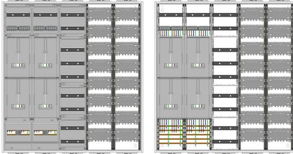
AZ102HS2M4-230-4, Zählerverteilung mit 3-Punktnach VDE 0603, DIN43870, AR-N 4101:2015 für den Innenbereich für Wandbefestigung AP/UP, Fabr. Alphatec, BxHxT [mm] = 1300x1400x230, Schutzklasse II, IP54, RAL 7035, Bestehend aus: Gehäuse, Einzel- bzw. Doppeltür mit Drehriegel, Flansche SF45 (oben) und SF41 (unten) und Berührungsschutzabdeckungen, aufgebaut wie folgt: 4xZählerplatz, Verteilerfeld (12TE), Medienfeld, externer APZ erforderlich, komplett zusammengebaut und verdrahtet gemäß VNB.0157
