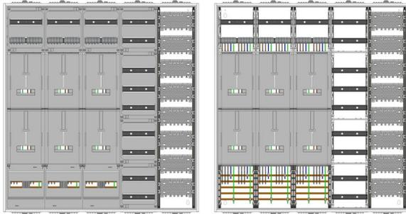
AZ102HS2M2-230-6, Zählerverteilung mit 3-Punktnach VDE 0603, DIN43870, AR-N 4101:2015 für den Innenbereich für Wandbefestigung AP/UP, Fabr. Alphatec, BxHxT [mm] = 1300x1400x230, Schutzklasse II, IP54, RAL 7035, Bestehend aus: Gehäuse, Einzel- bzw. Doppeltür mit Drehriegel, Flansche SF45 (oben) und SF41 (unten) und Berührungsschutzabdeckungen, aufgebaut wie folgt: 6xZählerplatz, Verteilerfeld (12TE), Medienfeld, externer APZ erforderlich, komplett zusammengebaut und verdrahtet gemäß VNB.0155
