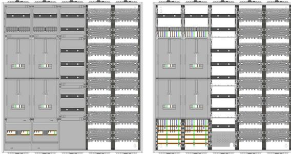
AZ102HS2AM2-230, Zählerverteilung mit 3-Punktnach VDE 0603, DIN43870, AR-N 4101:2015 für den Innenbereich für Wandbefestigung AP/UP, Fabr. Alphatec, BxHxT [mm] = 1300x1400x230, Schutzklasse II, IP54, RAL 7035, Bestehend aus: Gehäuse, Einzel- bzw. Doppeltür mit Drehriegel, Flansche SF45 (oben) und SF41 (unten) und Berührungsschutzabdeckungen, aufgebaut wie folgt: 4xZählerplatz, Verteilerfeld (12TE), APZ in Verteilerfeld, Medienfeld, komplett zusammengebaut und verdrahtet gemäß VNB.0204
