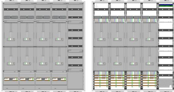
AZ102HS2A-210, Zählerverteilung mit 3-Punktbefestigung nach VDE 0603, DIN43870, AR-N 4101:2015 für den Innenbereich für Wandbefestigung AP/UP, Fabr. Alphatec, BxHxT [mm] = 1300x1400x210, Schutzklasse II, IP41, RAL 9016, Bestehend aus: Gehäuse, Einzel- bzw. Doppeltür mit Drehriegel, Flansche NF1 (oben) und NF2 (unten) und Berührungsschutzabdeckungen, aufgebaut wie folgt: 7xZählerplatz, TSG, Verteilerfeld (12TE), APZ in Verteilerfeld, komplett zusammengebaut und verdrahtet gemäß VNB.0081
