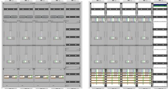
AZ102HS2-230-8, Zählerverteilung mit 3-Punktnach VDE 0603, DIN43870, AR-N 4101:2015 für den Innenbereich für Wandbefestigung AP/UP, Fabr. Alphatec, BxHxT [mm] = 1300x1400x230, Schutzklasse II, IP54, RAL 7035, Bestehend aus: Gehäuse, Einzel- bzw. Doppeltür mit Drehriegel, Flansche SF45 (oben) und SF41 (unten) und Berührungsschutzabdeckungen, aufgebaut wie folgt: 8xZählerplatz, Verteilerfeld (12TE), externer APZ erforderlich, komplett zusammengebaut und verdrahtet gemäß VNB.0153
