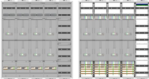
AZ102HS2-210-8, Zählerverteilung für Zählerplatz mit 3-Punktbefestigung nach VDE 0603, DIN43870, AR-N 4101:2015 für den Innenbereich für Wandbefestigung AP/UP, Fabr. Alphatec, BxHxT [mm] = 1300x1400x210, Schutzklasse II, IP41, RAL 9016, Bestehend aus: Gehäuse, Doppeltür mit Drehriegel, Flansche NF1 (oben) und NF2 (unten) und Berührungsschutzabdeckungen, aufgebaut wie folgt: 8x Zählerplatz, 9x Hutschienen in Verteilerfeld 1 (12TE), komplett zusammengebaut und verdrahtet gemäß VNB.0001
