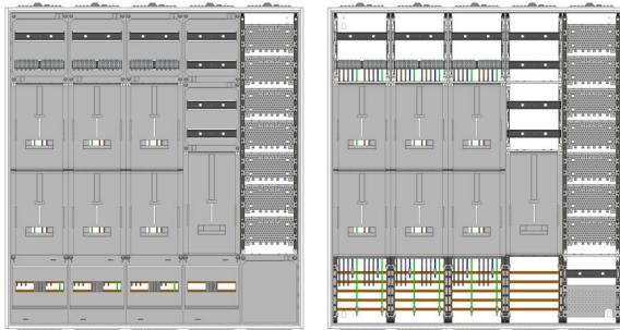
AZ102HS1M2A-210-2, Zählerverteilung mit 3-Punktbefestigung nach VDE 0603, DIN43870, AR-N 4101:2015 für den Innenbereich für Wandbefestigung AP/UP, Fabr. Alphatec, BxHxT [mm] = 1300x1400x210, Schutzklasse II, IP41, RAL 9016, Bestehend aus: Gehäuse, Einzel- bzw. Doppeltür mit Drehriegel, Flansche NF1 (oben) und NF2 (unten) und Berührungsschutzabdeckungen, aufgebaut wie folgt: 7xZählerplatz, Verteilerfeld (12TE), APZ in Medienfeld, komplett zusammengebaut und verdrahtet gemäß VNB.0080
