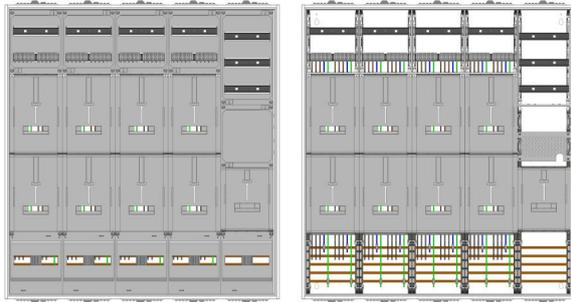
AZ102HS1A-230, Zählerverteilung mit 3-Punktnach VDE 0603, DIN43870, AR-N 4101:2015 für den Innenbereich für Wandbefestigung AP/UP, Fabr. Alphatec, BxHxT [mm] = 1300x1400x230, Schutzklasse II, IP54, RAL 7035, Bestehend aus: Gehäuse, Einzel- bzw. Doppeltür mit Drehriegel, Flansche SF45 (oben) und SF41 (unten) und Berührungsschutzabdeckungen, aufgebaut wie folgt: 8xZählerplatz, TSG, Verteilerfeld (12TE), APZ in Verteilerfeld, komplett zusammengebaut und verdrahtet gemäß VNB.0196
