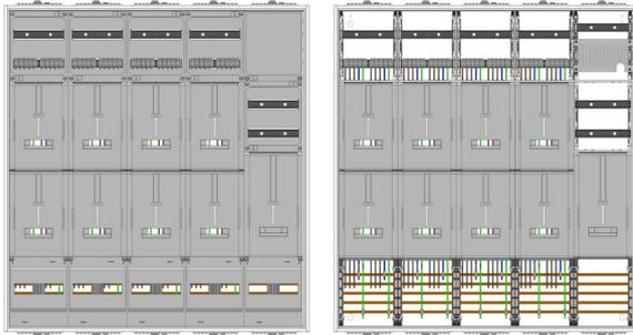
AZ102HS1A-210, Zählerverteilung mit 3-Punktbefestigung nach VDE 0603, DIN43870, AR-N 4101:2015 für den Innenbereich für Wandbefestigung AP/UP, Fabr. Alphatec, BxHxT [mm] = 1300x1400x210, Schutzklasse II, IP41, RAL 9016, Bestehend aus: Gehäuse, Einzel- bzw. Doppeltür mit Drehriegel, Flansche NF1 (oben) und NF2 (unten) und Berührungsschutzabdeckungen, aufgebaut wie folgt: 8xZählerplatz, TSG, Verteilerfeld (12TE), APZ in Verteilerfeld, komplett zusammengebaut und verdrahtet gemäß VNB.0075
