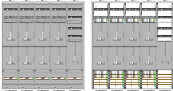
AZ102HS1-230-9, Zählerverteilung mit 3-Punktnach VDE 0603, DIN43870, AR-N 4101:2015 für den Innenbereich für Wandbefestigung AP/UP, Fabr. Alphatec, BxHxT [mm] = 1300x1400x230, Schutzklasse II, IP54, RAL 7035, Bestehend aus: Gehäuse, Einzel- bzw. Doppeltür mit Drehriegel, Flansche SF45 (oben) und SF41 (unten) und Berührungsschutzabdeckungen, aufgebaut wie folgt: 9xZählerplatz, Verteilerfeld (12TE), externer APZ erforderlich, komplett zusammengebaut und verdrahtet gemäß VNB.0150
