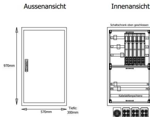
AVKNH5-00-2-6-300 M-Automatenverteiler, AVK, BxHxT = 570x970x300 Schutzklasse II, IP54, RAL 7035, Aufputz Bestehend aus:Gehäuse, Einzeltür mit Schwenkhebel für PHZ, Gehäuse geschlossen (oben) und 1x KFL2-240, 3x KFL2-4/35 (unten), 1x Geräteträger 2-Feld breit mit Feldabdeckungen PRL
