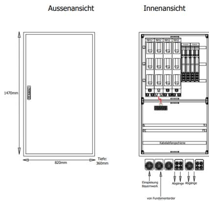
AVKNH4-4-3-9-360 M-Automatenverteiler, AVK, BxHxT = 820x1420x360 Schutzklasse II, IP54, RAL 7035, Aufputz Bestehend aus:Gehäuse, Einzeltür mit Schwenkhebel für PHZ, Flansche SF32 (oben) und 4x KFL2-240, 2x KFL2-4/35 (unten), 1x Geräteträger 3-Feld breit mit Feldabdeckungen PRL
