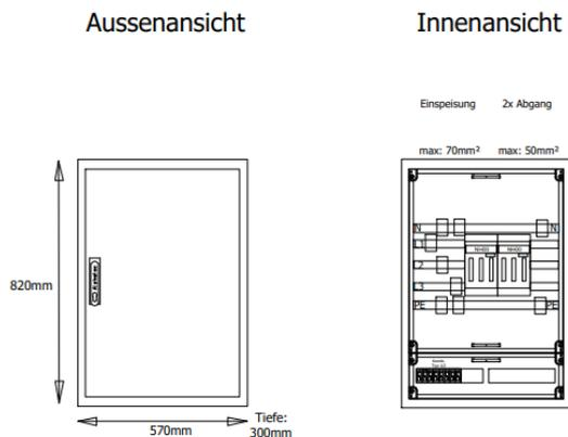
AVKNH2TR-2-4-300 M-Automatenverteiler, AVK, BxHxT = 570x820x300 Schutzklasse II, IP54, RAL 7035, Aufputz Bestehend aus: Gehäuse, Einzeltür mit Schwenkhebel für PHZ, Flansche SF38 (oben) und SF32 (unten), 1x Geräteträger 2-Feld breit mit Feldabdeckungen PRL
