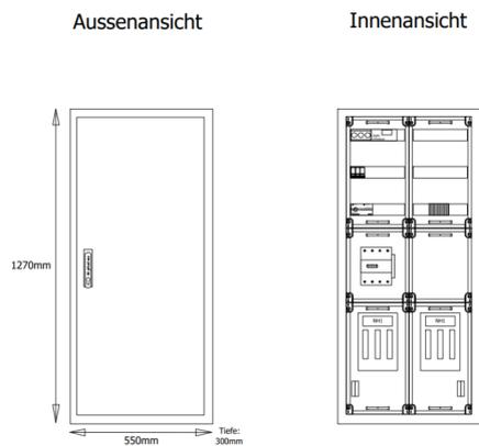
AVKNA90-2-8-300 V-Automatenverteiler, AVK, BxHxT = 570x1270x300 Schutzklasse II, IP54, RAL 7035, Aufputz Bestehend aus:Gehäuse, Einzeltür mit Schwenkhebel für PHZ, Flansche SF32 (oben) und SF39 (unten), 1x Geräteträger mit Feldabdeckungen PRL
