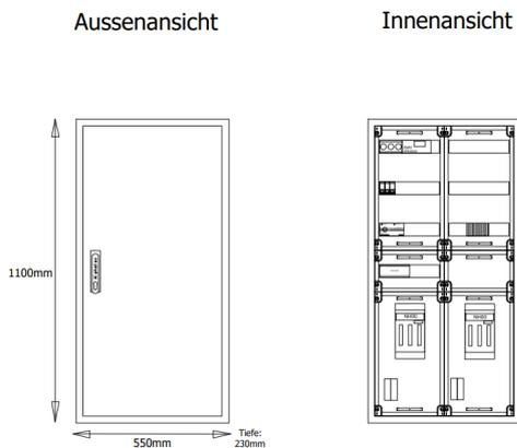
AVKNA50-2-7-230 M-Automatenverteiler, AVK, BxHxT = 550x1100x230 Schutzklasse II, IP54, RAL 7035, Aufputz Bestehend aus:Gehäuse, Einzeltür mit Schwenkhebel für PHZ, Flansche SF41 (oben) und SF45 (unten), 1x Geräteträger mit Feldabdeckungen PRL best. mit
