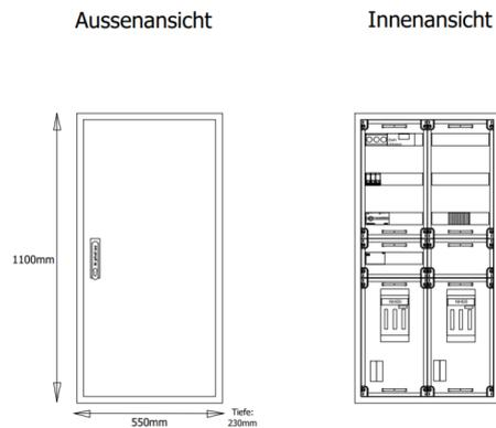
AVKNA35-2-7-230 M-Automatenverteiler, AVK, BxHxT = 550x1100x230 Schutzklasse II, IP54, RAL 7035, Aufputz Bestehend aus:Gehäuse, Einzeltür mit Schwenkhebel für PHZ, Flansche SF41 (oben) und SF45 (unten), 1x Geräteträger mit Feldabdeckungen PRL best. mit
